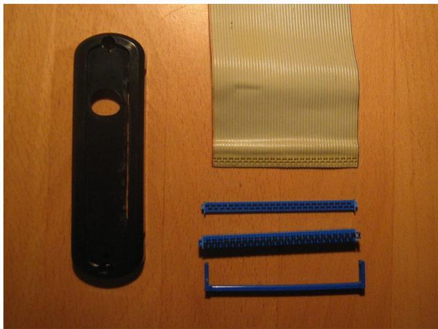
5. Die Frontblende vorbereiten. Einen Schlitz für das Flachbandkabel schneiden und ein Loch für den PS2-Stecker bohren. Den Platinenstecker vorsichtig zerlegen, durchführen und mit einer Crimpzange zusammenquetschen. Eine Türzarge tut es zur Not auch.
