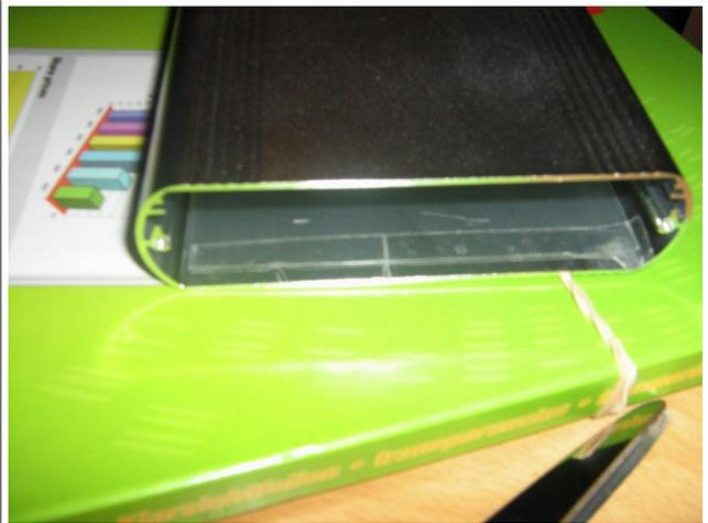
6. Bei Metallgehäusen sollte das Innere mit Folie ausgekleidet werden, um Kurzschlüsse zu vermeiden. Wenn genug Platz vorhanden ist, kann das Symbiface auch verschraubt werden.
